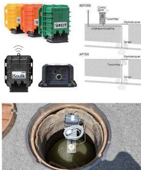
iSouluk 使用电池、太阳能或商用电力, 是能自动连接其他公司传感器、在同类产品中具有最高可靠性的强大装置。其测定的感应数据可被云服务器以及/或专用服务器收集和传输。通过基于网络的图像数据管理系统(StreamView), 可实现数据的监视和控制, 且能和SCADA以及其他公司的软件、模型通用。
